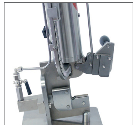
Rafferauslösung und abschaltbares Abschneidemesser.
