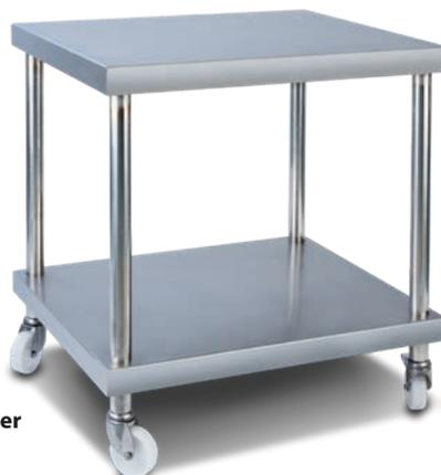
▷ **Unterwagen aus Edelstahl** AISI 304 Vier Lenkrollen, zwei davon mit Feststellbremse Breite/Länge/Höhe 500/600/650mm.
