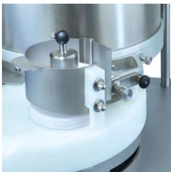
▷ **Automatischer Trennpapier-Einzug für Hamburger** von 80 bis 115mm Durchmesser.
